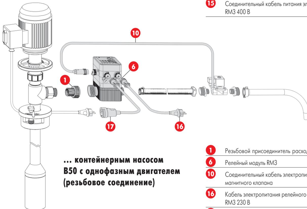
**... контейнерным насосом В50 с однофазным двигателем (резьбовое соединение)**
