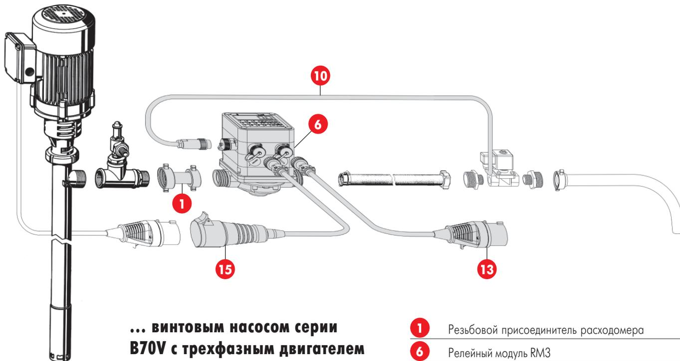
**... винтовым насосом серии В70V с трехфазным двигателем (резьбовое соединение)**
