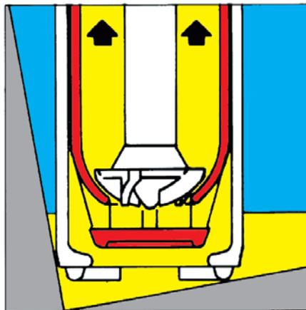
Затворная крышка открыта – жидкость выкачивается из емкости.
