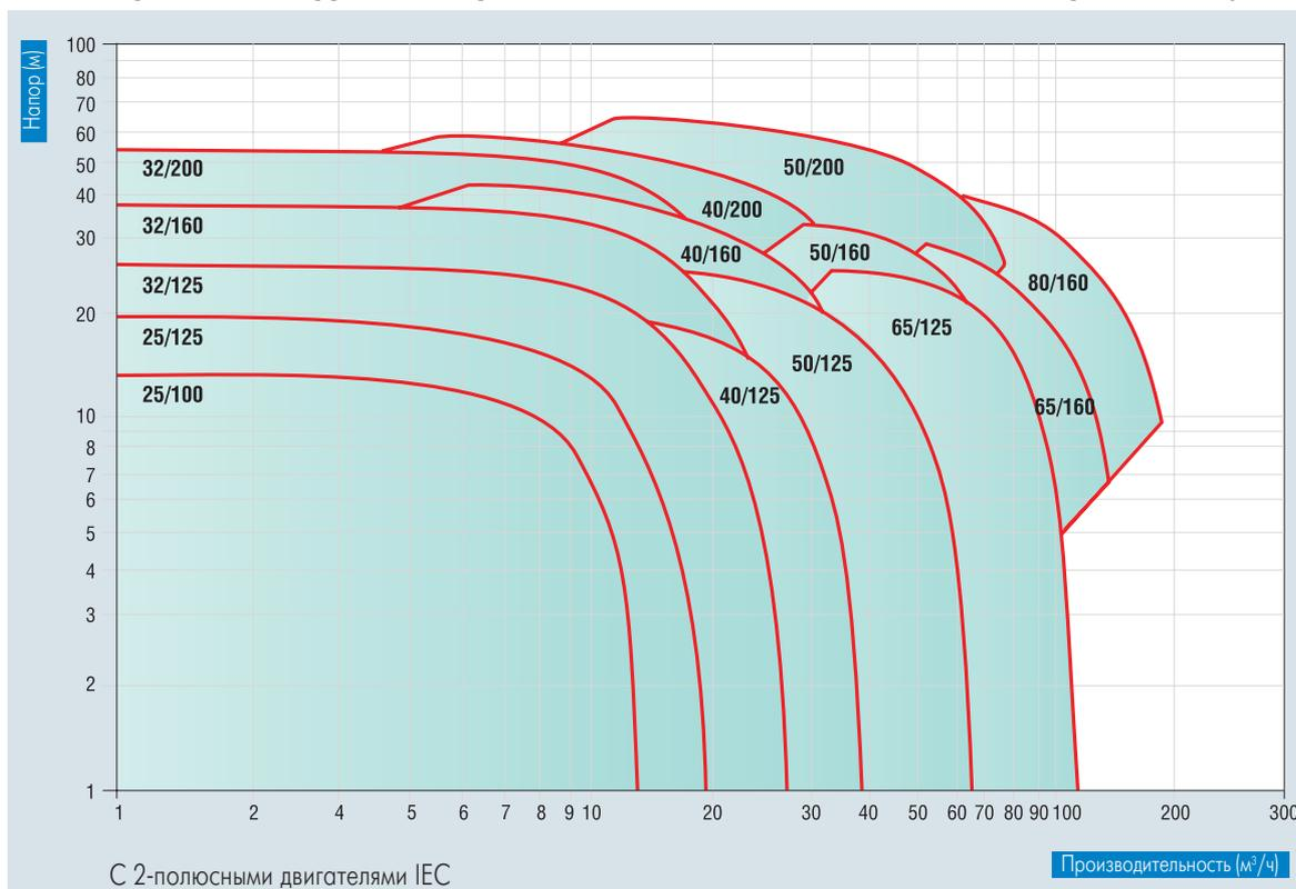
Рабочие кривые для погружных центробежных насосов с номинальным числом оборотов 1450 1/мин.
