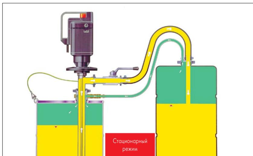
В наши дни очень большое внимание уделяется снижению загрязнения воздуха. Компания Lutz делает все, что в ее силах, для охраны окружающей среды. Мы доработали наш бочковой адаптер, предотвращающий утечки, встроив его в комплексную газоотводную систему. Вредные газы и пары, образующиеся при перекачке опасных жидкостей, почти не выходят за пределы практически полностью замкнутой системы, обеспечивающей необходимую компенсацию давления без утечек в атмосферу.
