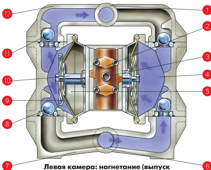
**Левая камера: нагнетание (выпуск жидкости) Правая камера: всасывание (впуск жидкости)**
